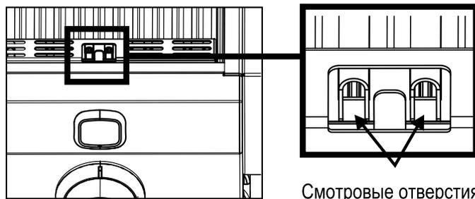
6. Если зажигания не произошло в течение 5 секунд, поверните ручки горелок в положение O подождите 5 минут и повторите процедуру
