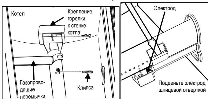
5. Осторожно поднимите каждую горелку и отсоедините от сопла клапана. Мы предлагаем три способа очистки труб горелки. Используйте тот, который вам наиболее удобен.
