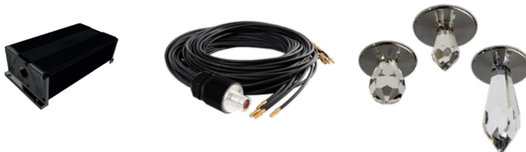
Комплекты Crystal Star включают жгут из пластмассового волокна, в котором кроме 100 тонких (0,75 мм) волокон есть 18 более толстых (3 мм) волокон с хрустальными насадками, 6 x CR-12, 6 x CR-16 и 6 x CR-31. В проекторе с эффектом мерцания источником света служат белые светодиоды, а с эффектом синего мерцания - синие светодиоды.
